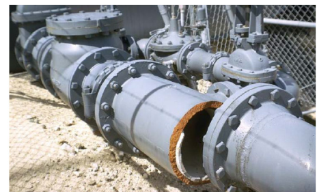
Bruch spröder Wasserrohre, San Fernando 1971
